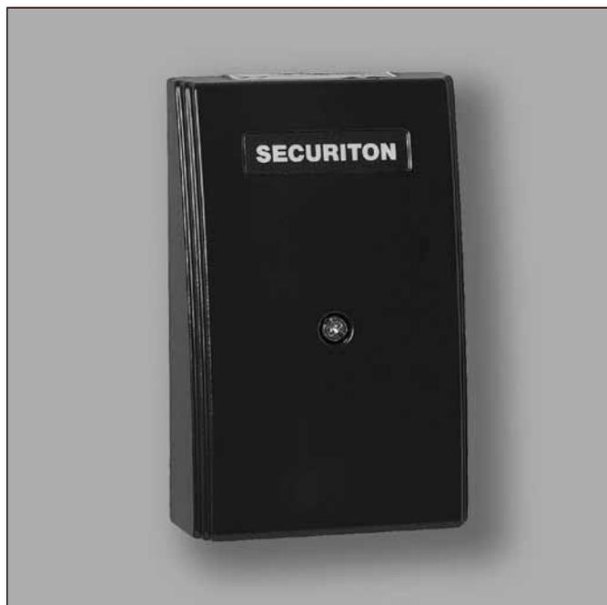
Einbruchgefährdete Wertbehältnisse werden mit dem Körperschallmelder KSM 412 zuverlässig überwacht. Eine ausgeklügelte Geräuschanalyse lässt sich in vielen Parametern dem zu schützenden Objekt und den typischen Einbruchgeräuschen anpassen. Damit ergibt sich eine hohe Ansprechsicherheit, auch bei sehr subtilen Einbruchmethoden über ein breites Anwendungsgebiet, vom klassischen Tresorbau bis zu Geldautomaten.
